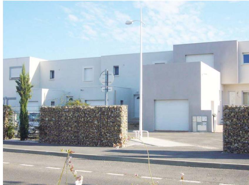
*Ici des gabions, non pas utilisés en parement de façades mais en murs de clôture (ZAC des Ferrières à Bellegarde)*
